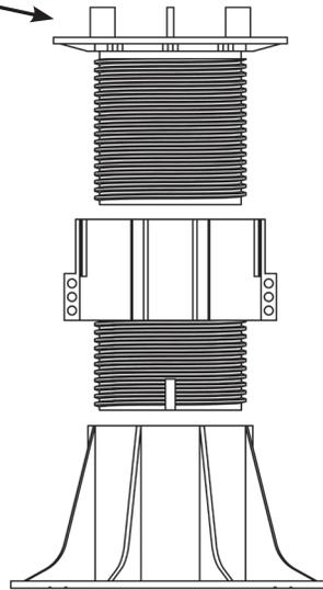
Los pedestales ScrewJack de Bison vienen completamente ensamblados, con la parte superior y la base en la posición más baja. Para aumentar la altura, simplemente desatornilla. NO exceder el seguro o tope, a menos que sea para agregar un Cople C4.
