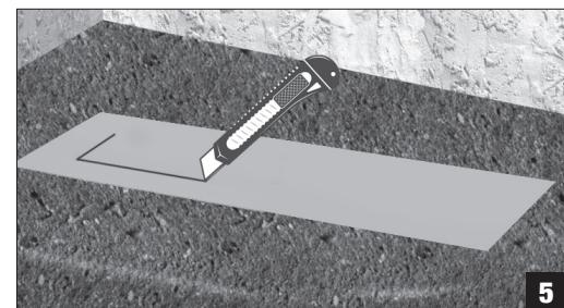
Dopo l'impermeabilizzazione di tutto il massetto con il nostro kit: con un cutter tagliare il telo e liberare la bacinella. Se non si usa il nostro kit, passare direttamente al punto 6.
