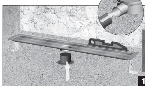
Collegare il tubo di scarico; regolare l'altezza di posa e livellare, tenendo conto dell'altezza del telaio e del rivestimento piastrelle.
