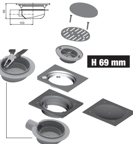
In caso di necessità è possibile ridurre l'altezza rompendo il bordo della Base.
