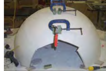
Montaje de 2 cuartos de pieza, la mitad de la concha
