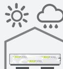
Las estibas de Cempanel® Cedar deberán descansar sobre una superficie plana y horizontal, sobre separadores de madera que lo eleven por lo menos 5 cm del nivel de piso, y separados a no más de 61 cm.
