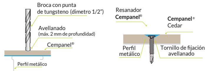
El corte del Cempanel® se debe hacer con maquinaria adecuada como sierra caladora o sierra circular con control de baja velocidad y el disco debe ser de punta de diamante o carburo de tungsteno.
