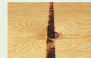
Quemadura de máquina
