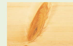
Nudo aserrado longitudinalmente
