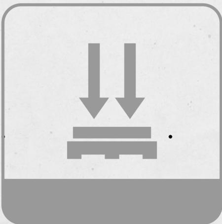
El tablero debe se almacenado en forma horizontal sobre una base plana rígida y aislada del suelo mediante separadores o pallets.
