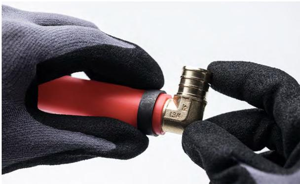
Después, inserte el cuerpo de la conexión en la tubería hasta el tope, asegurando que la conexión y la tubería estén libres de cualquier rebaba o impurezas
