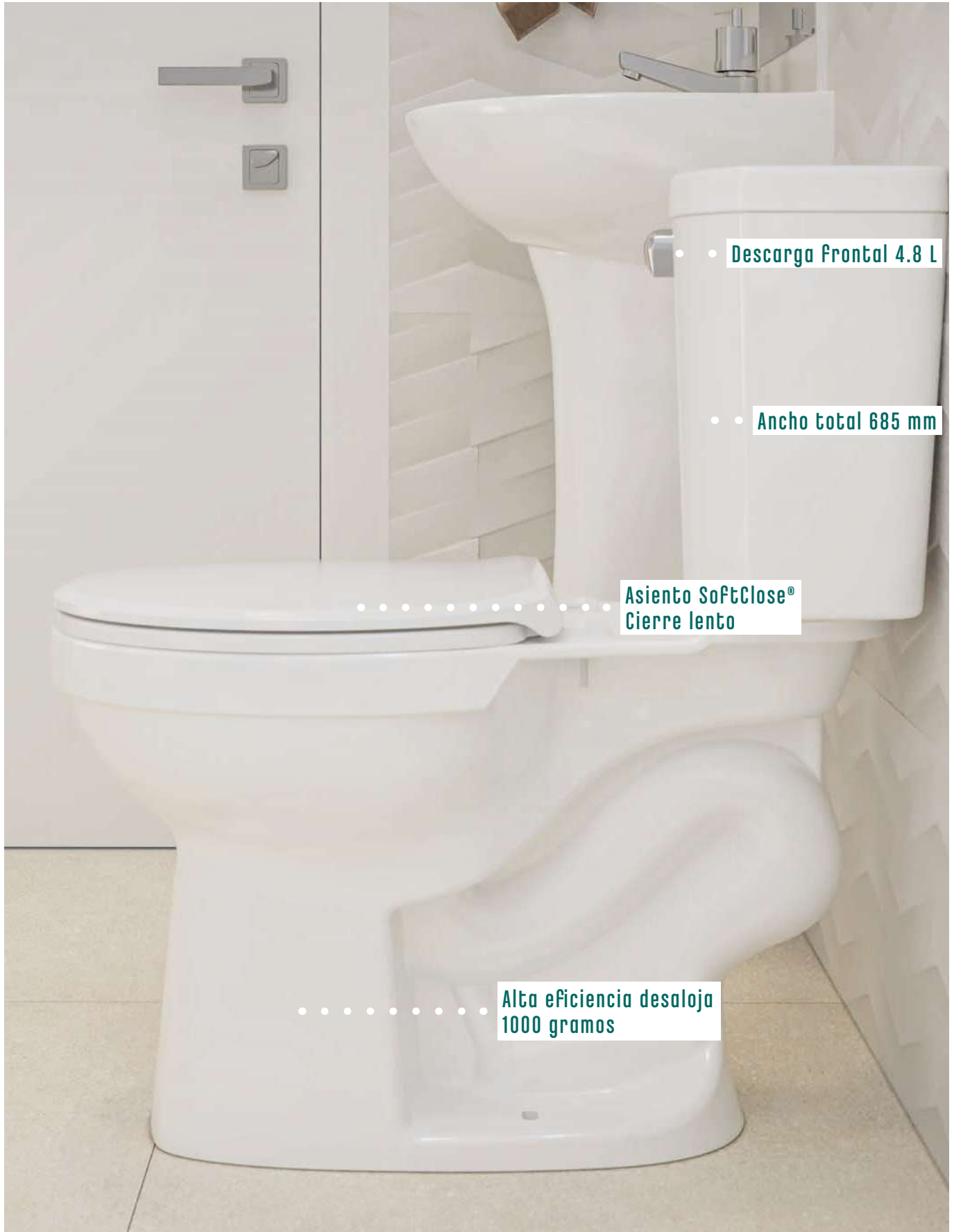
Taza, tanque EcoFlush® 4.8 litros y asiento SoftClose® Celite Lift.
