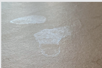
Situaciones típicas que ocurren sobre gres porcelánico debido a la formación de películas superficiales.
