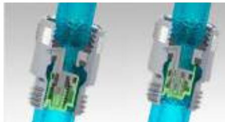
En Wassersiempre estás pensando en ti, nuestros limitadores de presión, cuentan con un pistón de control/duo que se mueve dinámicamente en combinación con un orificio de equilibrio, garantiza una presión constante baja independientemente de la presión de la línea, por ejemplo, 1 bar (14,5 psi) para una presión del sistema de entre 1 y 10 bar. (14,5 a 145 psi).
